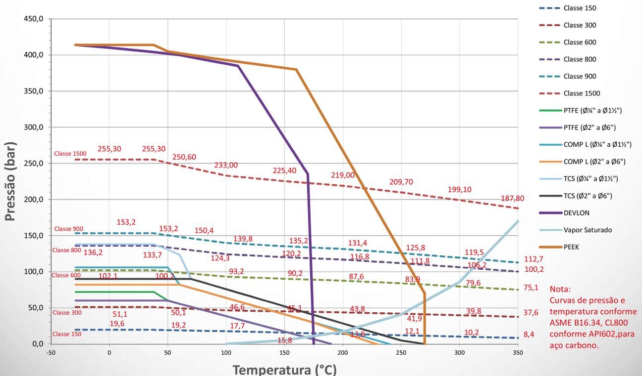
Para aplicação em vapor saturado, a temperatura máxima de operação é de 200°C e a pressão máxima de operação é de 16 bar g.
