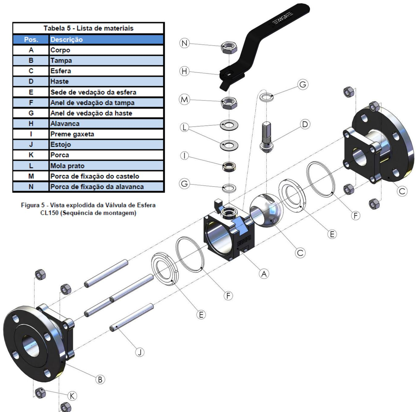
Figura 5 - Vista explodida da Válvula de Esfera CL150 (Sequência de montagem)
