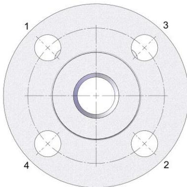
Figura 2 – Sequência de aperto dos parafusos Flange Classe 150.
