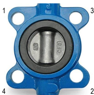
Figura 3 – Sequência de aperto dos parafusos do flange.
