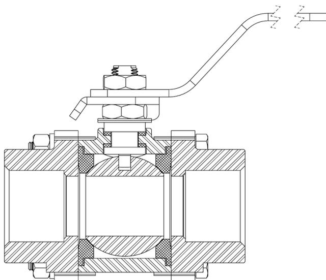
Figura 1 – Corte transversal da VET CL 300 Montada.
