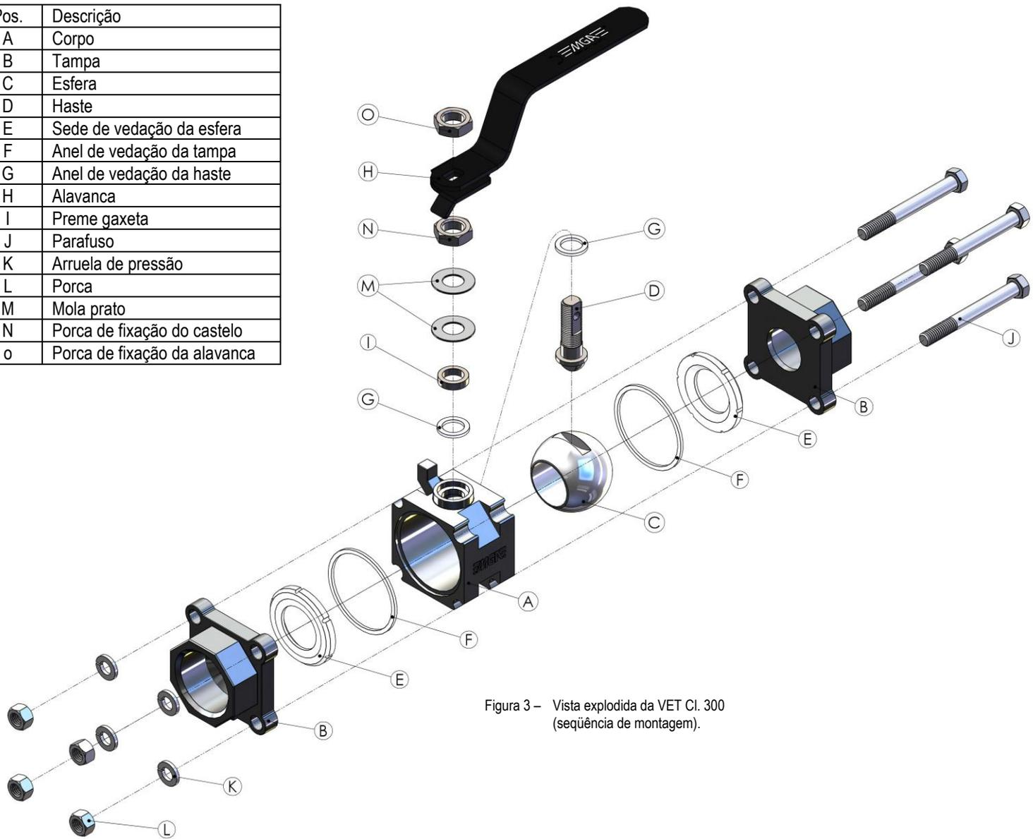
Figura 3 – Vista explodida da VET CI. 300 (seqüência de montagem).
