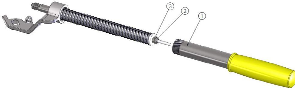
Desrosquear tubo de acionamento (1), soltar contraporca (2), realizar aperto em meia volta na porca de aperto (3), remontar dispositivo e realizar teste de acionamento/fechamento. Caso necessário repita o procedimento até obter o fechamento ideal.
